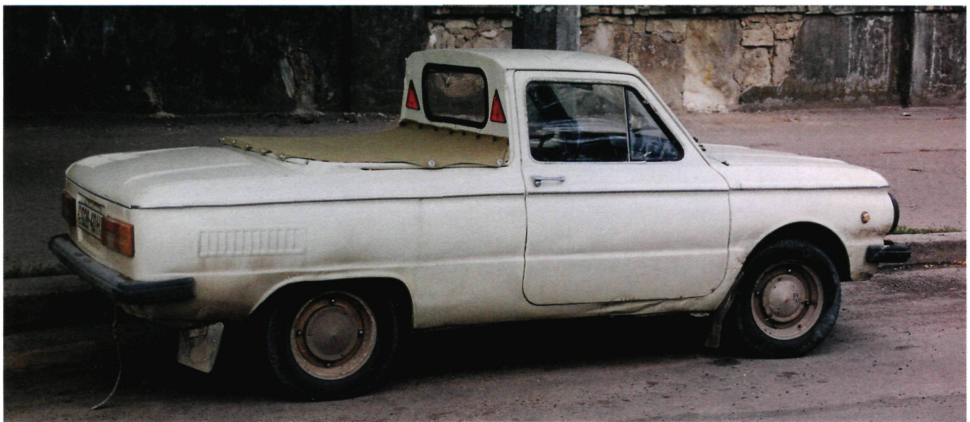
ЗАЗ-968МР с электровакуумным приводом сцепления для инвалидов, имеющих одну руку и одну ногу.
