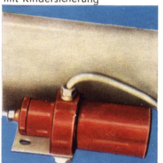
Bremskraftbegrenzer für die Hinterräder
