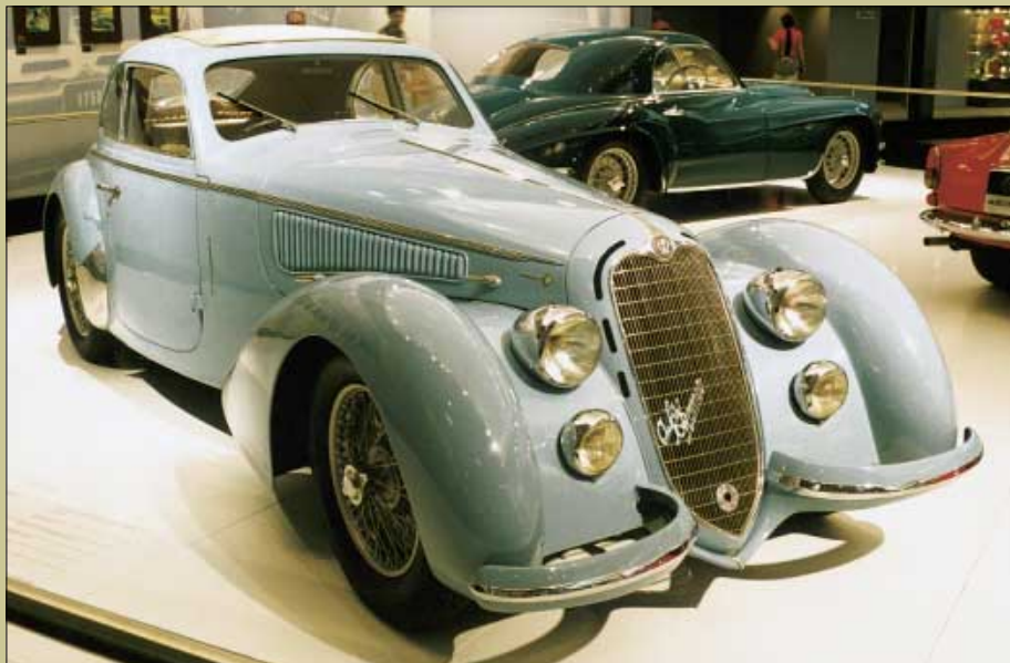
Alfa Romeo 8C 2900 B Lungo, 8 цилиндров, 2905 см куб., 180 л.с., 175 км/ч, кузов Touring, 1938 год.
