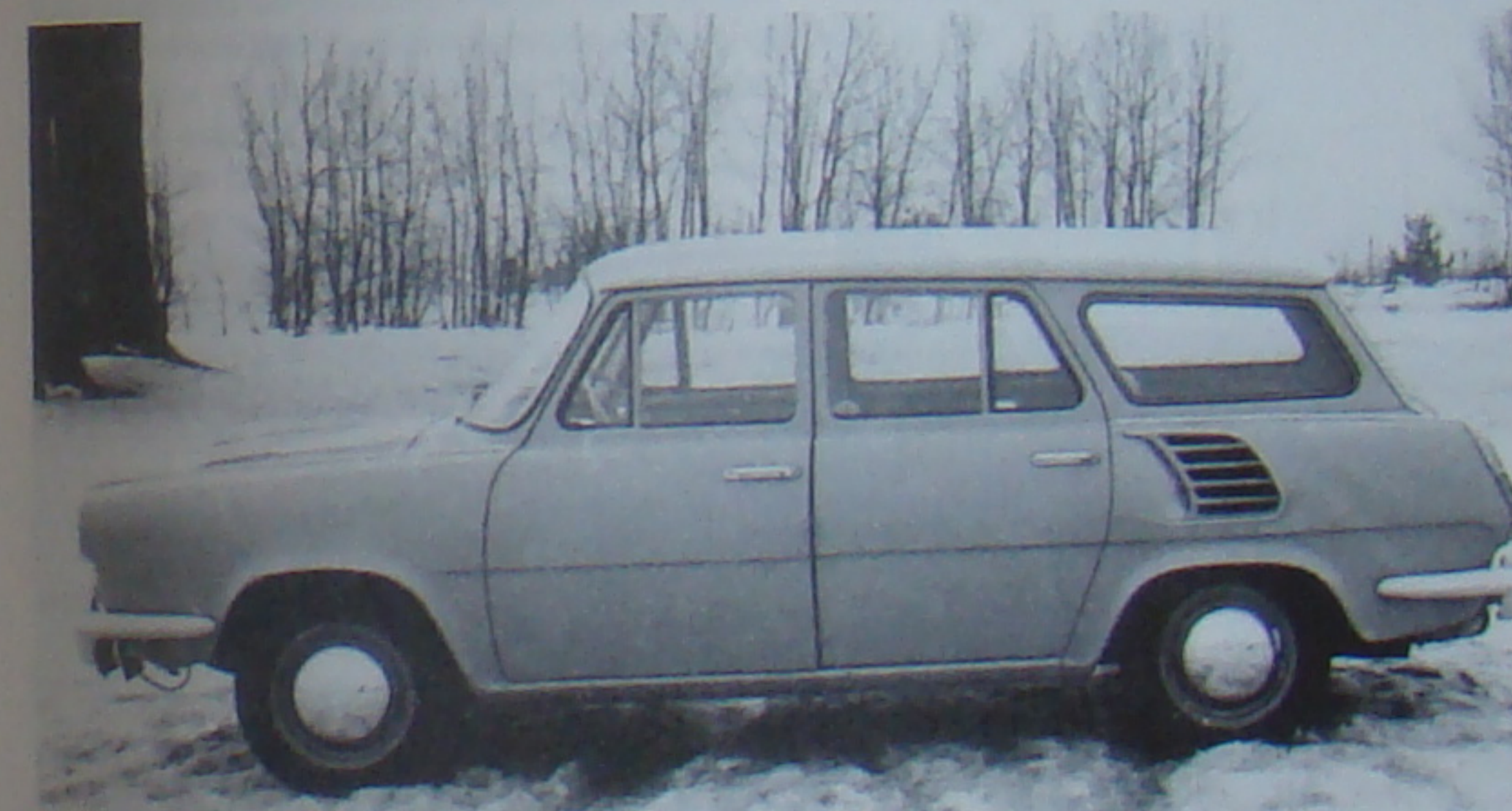
Прототипът на комби то ясно показва огромния товар на задната ос на напълно натоварена кола. По тази причина тя не влиза в производство.
