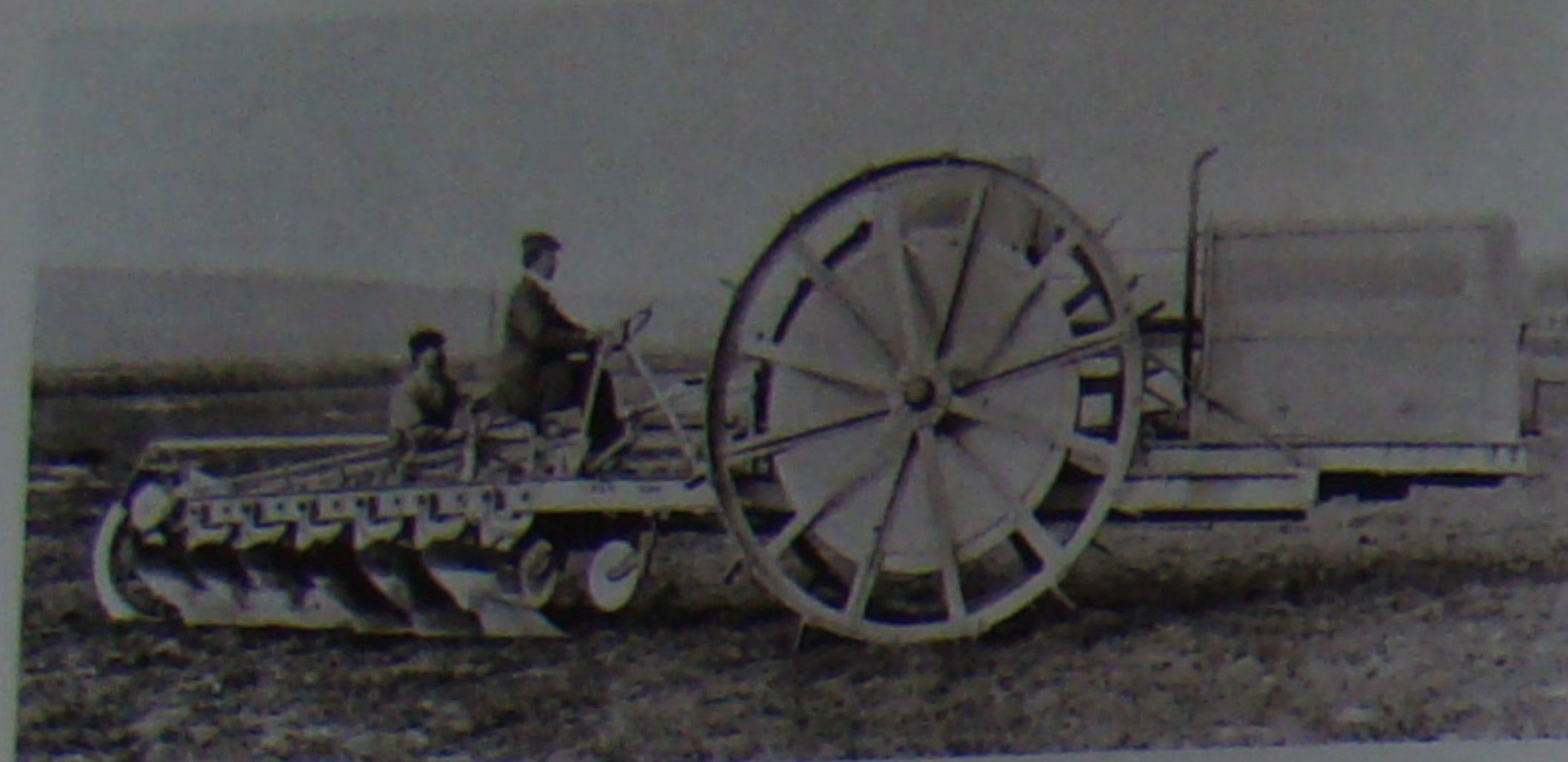
Огромният моторен плуг Екселсиор е дълъг 9м, има чифт предни задвижващи колела с диаметър 2.2м и задно управляващо колело.
