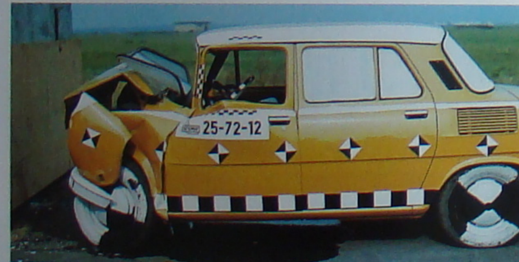
В началото на 1970-те вече се обръща внимание на нивото на пасивната безопасност. Шкода 100 при краш тест
