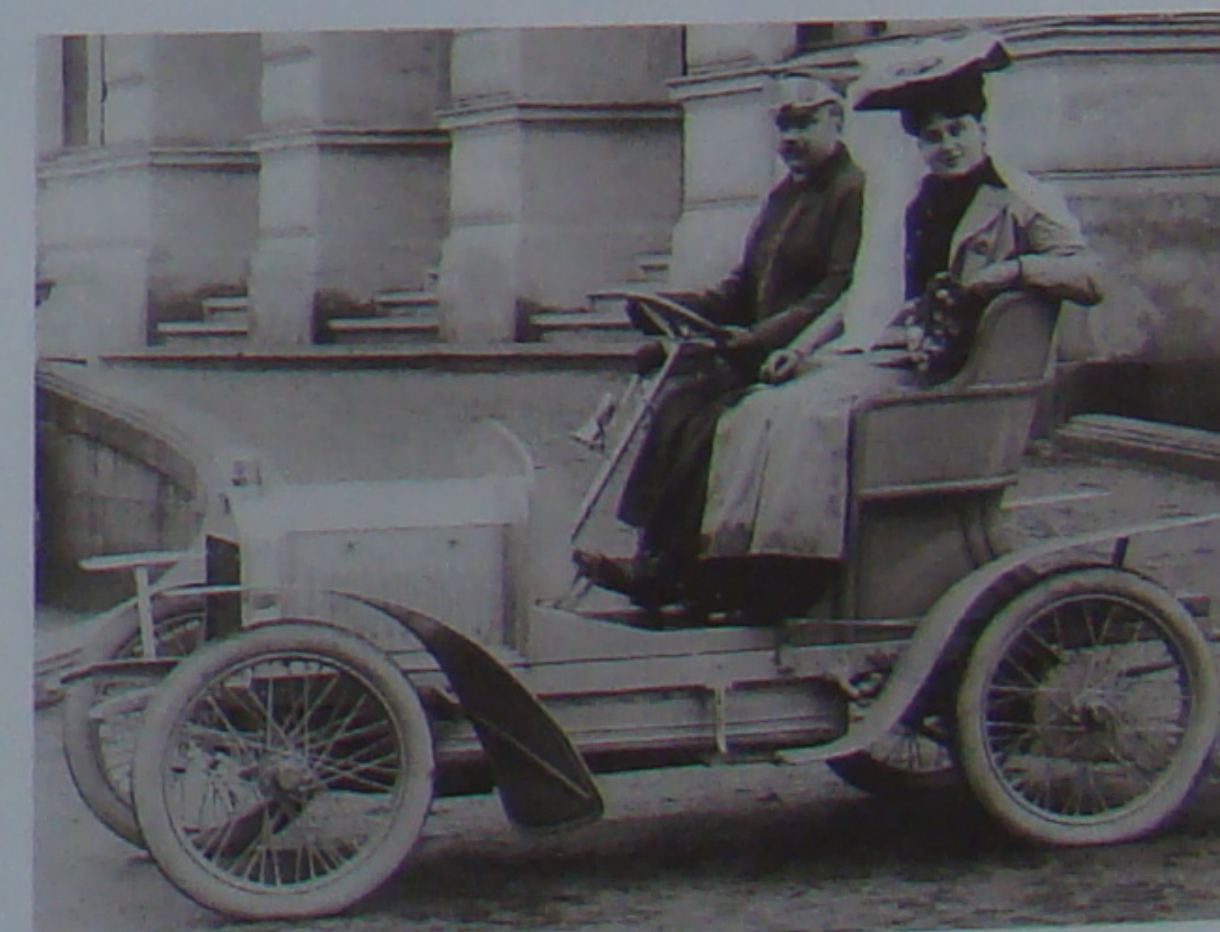
Моделът L&K min A Voiturette, с двучилиндров двигател с обем 1005 куб. см и мощност 7 к.с., достигал максимална скорост 40 км/ч.
