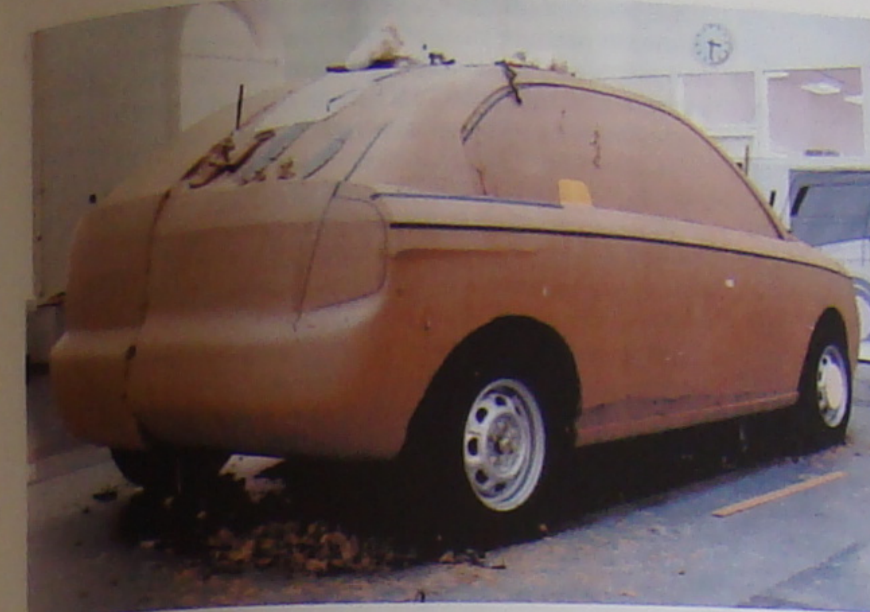
Глинен модел на разработваната Фабия в мащаб 1 към 1
