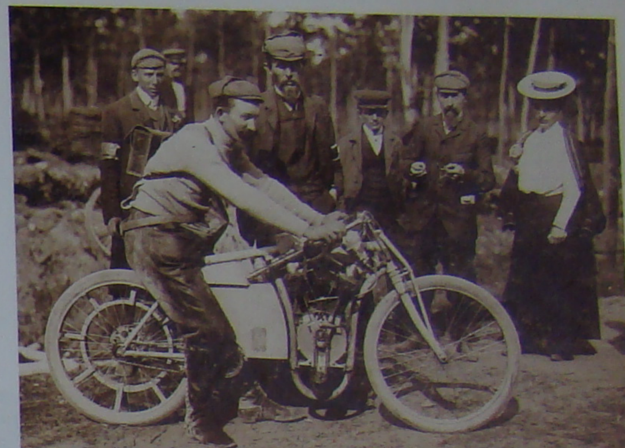
Вацлав Вондрих на финала на състезанието "Гордън Бенет Кап" в Дурдан през 1905 г. Двучилиндровият мотоциклет с обем 693 куб. см, можел да достигне максимална скорост над 100 км/час. Зад Вондрих е самият Вацлав Клемент.
