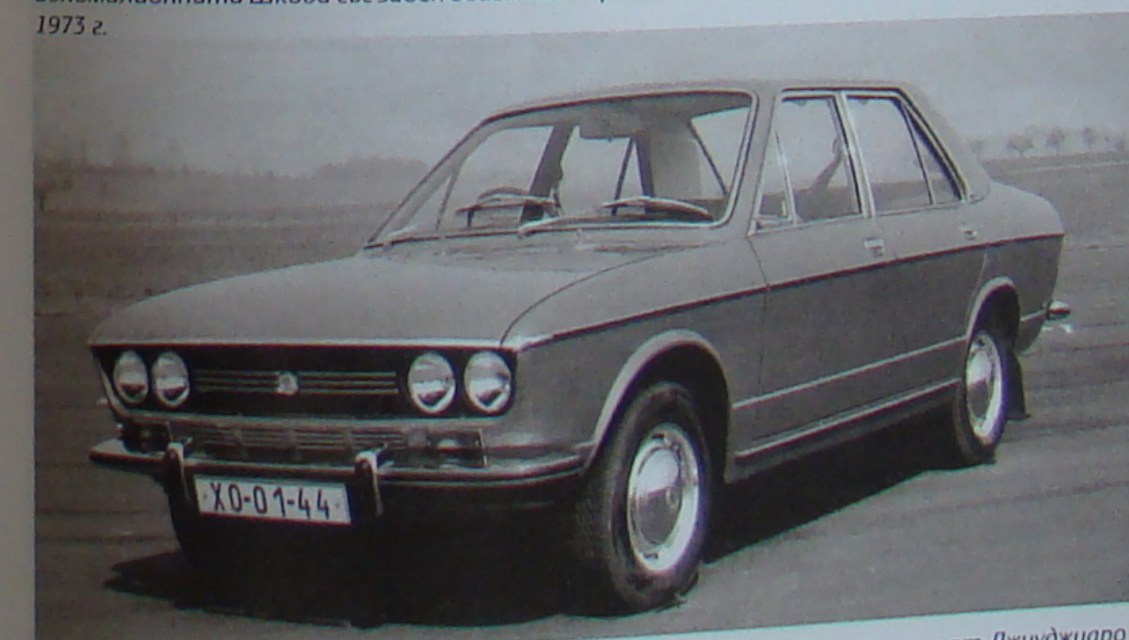
Прототип на невидялата бял свят Шкода 720 с каросерия, конструирана от Джиуджиаро и ОНС 1500 cc двигател, която е един пропилан шанс
