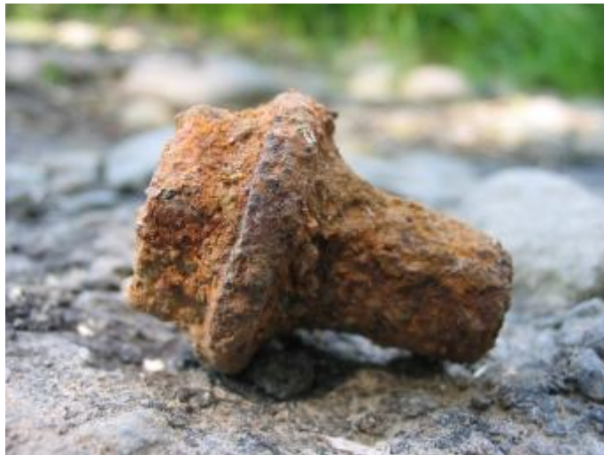
Фигура 7 Обща равномерна корозия на стоманен болт
