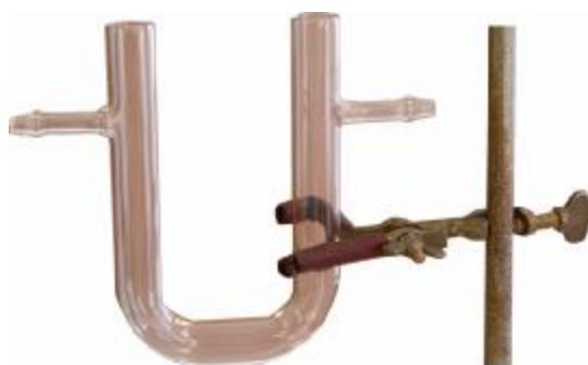
Фигура 6 U-видна тръба за провеждане на електролизата
