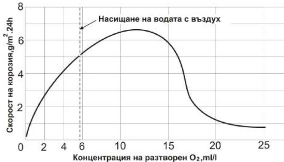
Фигура 11. Зависимост на скоростта на корозия на въглеродна стомана от концентрацията на разтворен кислород в деминерализирана вода
