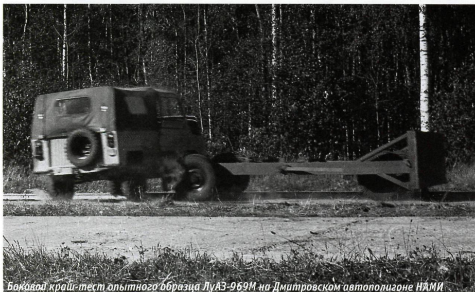
Боксевой краш-тест опытного образца ЛуАЗ-969М на Дмитровском автополигоне НАМИ
